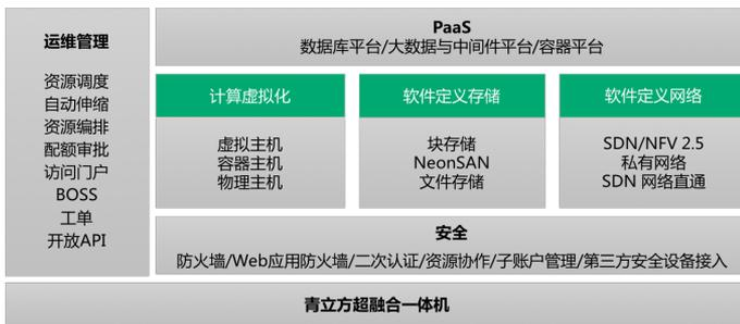
图二 基于x86架构服务器的青云QingCloud企业云平台
